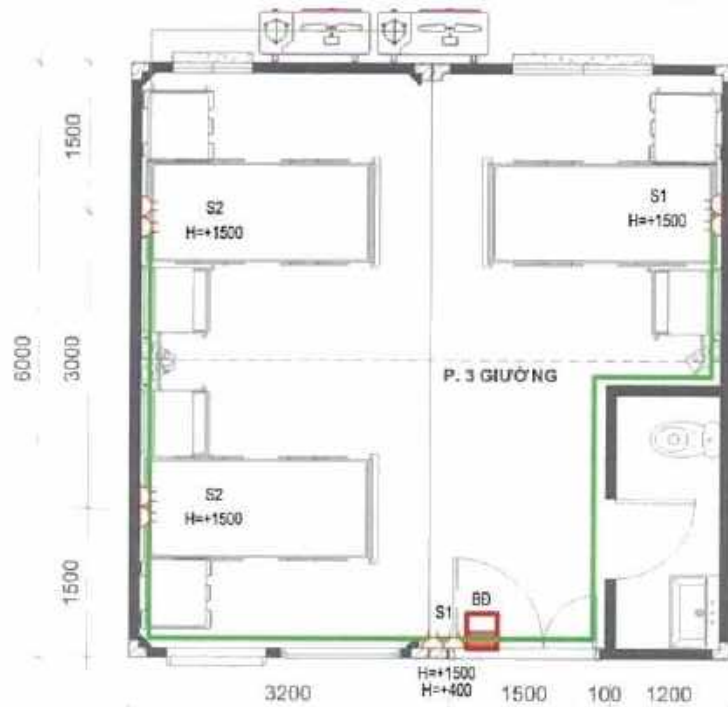
MẶT BẰNG CẤP ĐIỆN
